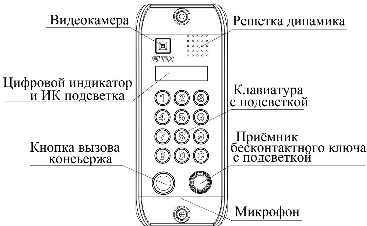
Рис.4 Внешний вид со стороны лицевой панели блоков вызова DP5000-KRDC42, DP5000-KRDC42-01, DP5000-KRDC42-02и DP5000-KRDC41-03
